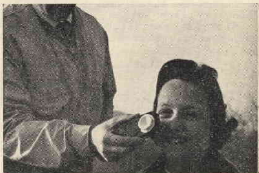
Fig. 13 - Per la misurazione dell'intensità di luce col sistema a luce incidente dirigeremo la cellula fotoelettrica — schermata — in direzione della macchina fotografica, mantenendoci prossimi al soggetto da riprendere.
