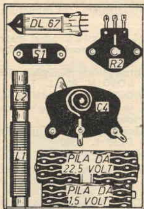
Fig. 3 - Allogamento componenti all'interno dell'astuccio in plastica
