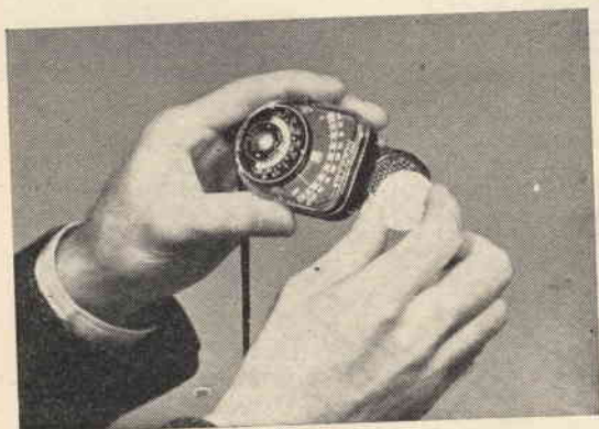
Fig. 12 - Adottando il sistema della luce incidente, necessiterà schermare la cellula fotoelettrica con l'apposito schermo bianco (nella foto: esposimetro I.C.E.).
