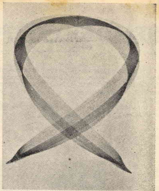
Fig. 5 - Altra variazione apportata alla lunghezza del tratto di spago che sostiene il pendolo ci portò al conseguimento del tracciato di cui a figura.
