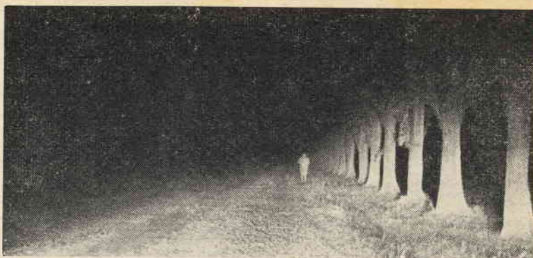
Fig. 4 - L'automobilista che viaggia invece con luci a fascio anabbagliante asimmetrico potrà scorgere l'ostacolo che si presenti sulla destra a grande distanza.
