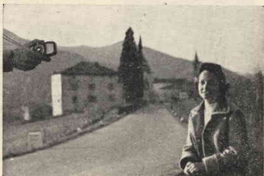
Fig. 11 - Misurazione errata: alla cellula non giungerà la luce riflessa dal soggetto, bensì quella dell'ambiente circostante.
